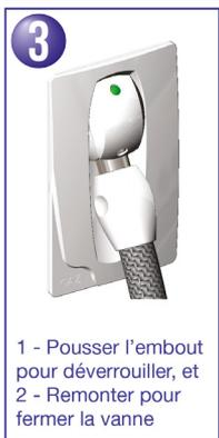
1 - Pousser l'embout pour déverrouiller, et 2 - Remonter pour fermer la vanne
